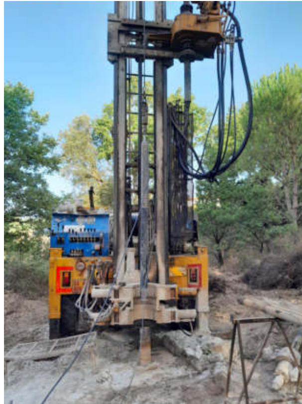
Figura 9-3- Esecuzione prove dilatometriche nel sondaggio S19-DH
